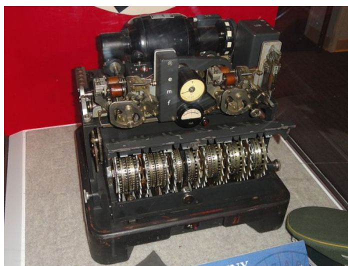
Dispositivo di cifratura Lorenz SZ40 (Wikimedia Commons, Daderot)
