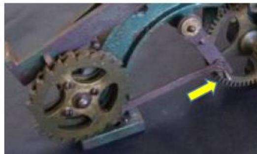
Sul braccio corto è posizionato un perno (unghiatore), premuto da una lamina-molla. La lamina ha la funzione di facilitare il contatto con il profilo della camma (blocco 12 pos. 12.17) che trasforma il moto rotatorio in moto rettilineo alternativo.
