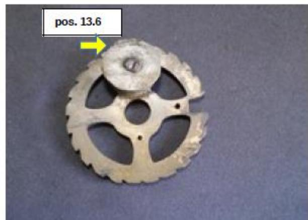
Sulla seconda ruota (pos. 13.6) è fissato, in posizione eccentrica, un disco massa in piombo che riporta ambedue le ruote nella posizione di gravità. Il collegamento tra il rotismo delle ore e quello dei quarti avviene con la leva di interscambio ore-quarti (pos. 13.7). La leva è montata sul supporto.
