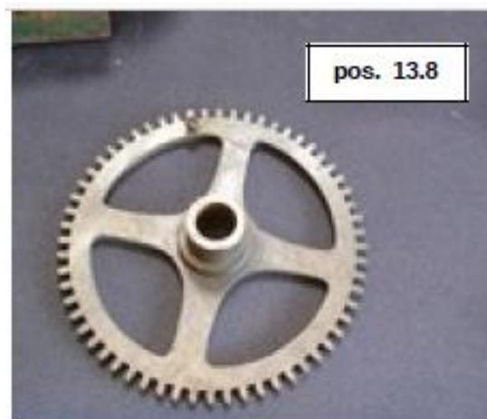
Sull'albero della prima ruota partitora (pos. 13.8) sono montate a "pacchetto" altre quattro ruote per la gestione delle suonerie delle ore le cui funzioni saranno descritte di seguito. Nella presente relazione saranno gestite le prime due ruote e la leva comando del gruppo partitore delle ore.
