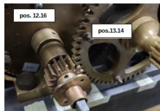
La ruota (pos. 13.14) muove un pignone con 10 denti che ingrana con una seconda ruota (pos. 13.8) che ha 60 denti, con un rapporto 10/60 ossia 1:6. Questa seconda ruota, facente parte del gruppo partitore, compie in 60 minuti un angolo di 15° (1/6 di 90°). Di conseguenza tale ruota compie un giro completo in 24 ore.
