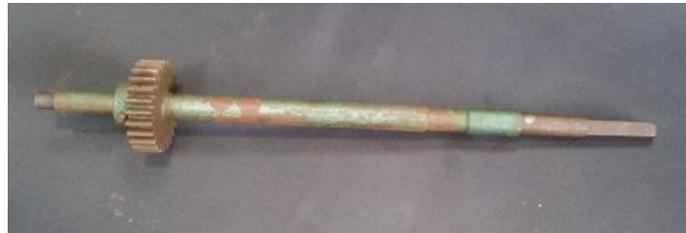
L'albero presenta, dal lato carica, un'estremità quadra idonea a ricevere la chiave della manovella di carica del gruppo del tempo e, dal lato pendolo, un'estremità con diametro ridotto che permette l'alloggio dell'albero in un foro del basamento.
