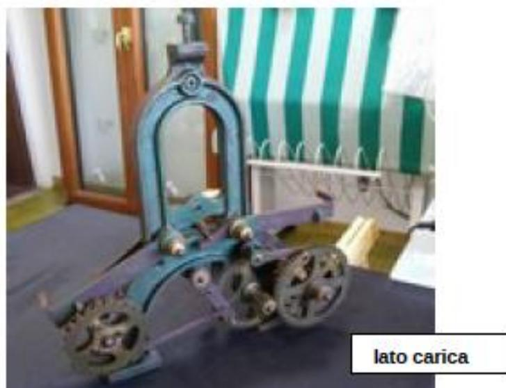
Sul supporto sono montate le leve del suono, di interfaccia delle ore e di interfaccia dei quarti: ambedue azionano le suonerie e controllano i movimenti di aggancio e sgancio delle suonerie. Sul supporto sono montate le ruote partitore (sia quelle del lato quarti sia quelle del lato ore) e la leva di interscambio ore -quarti.
