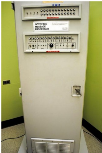
Honeywell 516, usato come Interface Message Processor (IMP), il primo Router di ARPANET
