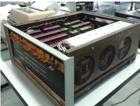
Telaio capovolto del PDP-8/L senza i pannelli
