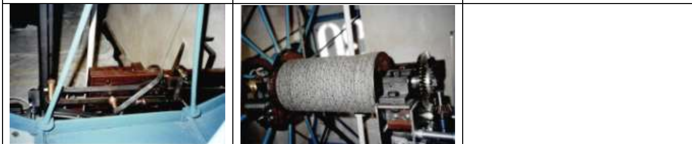
Vista dei dispositivi di automazione delle vele dei giorni e dei minuti
