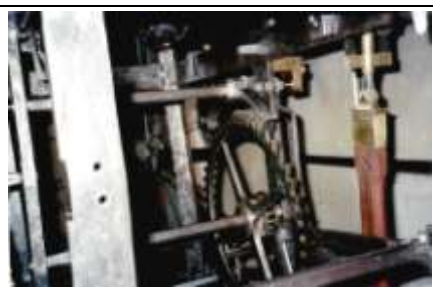
Vista dell'orologio e del dispositivo per la ricarica automatica dei pesi
